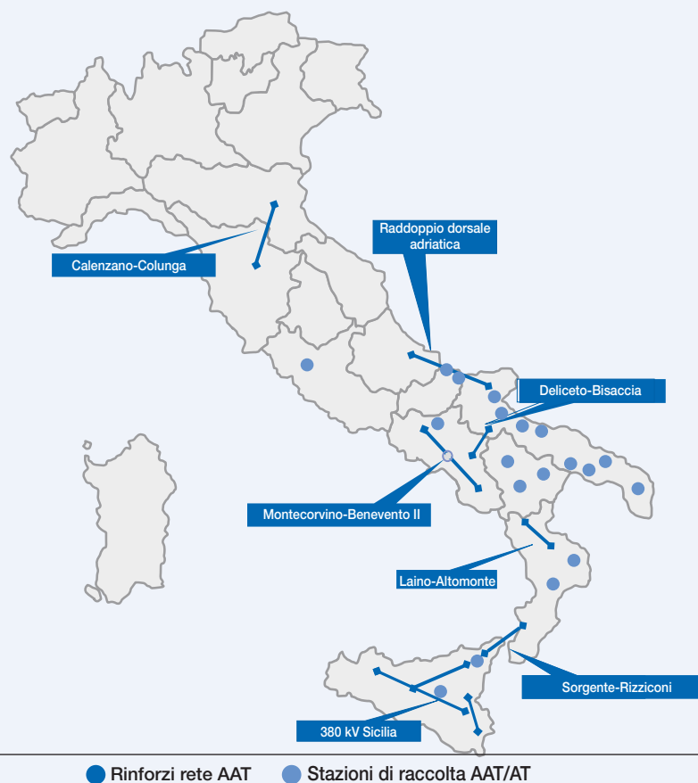
Figura 2 - Principali interventi sulla rete 380 kV necessari per il pieno utilizzo dell'energia proveniente dalla produzione di impianti da fonti rinnovabili
