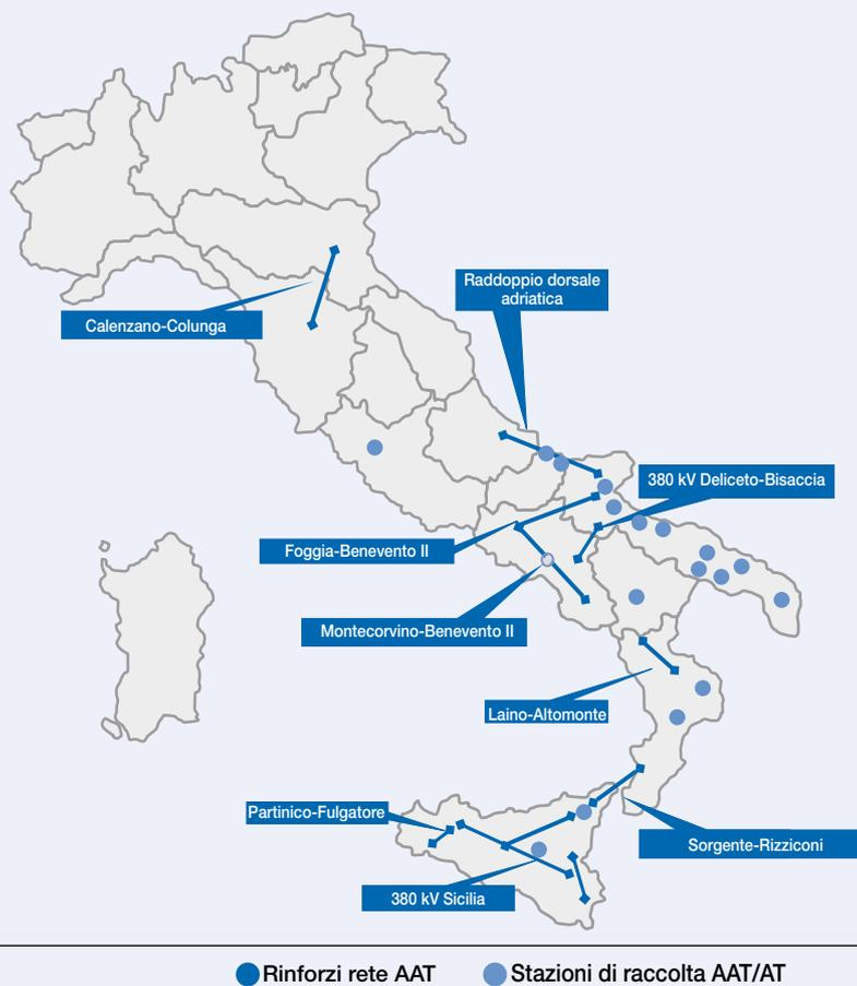
Figura 2 - Principali interventi sulla rete 380 kV necessari per il pieno utilizzo dell'energia proveniente dalla produzione di impianti da fonti rinnovabili
