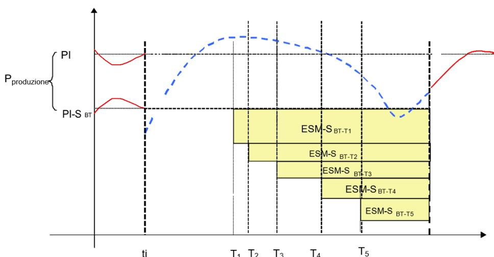
**Figura 5 - Calcolo della energia fornita per i servizi di mitigazione per utenti finali BT ( $ESM$ )<sub>BT</sub>**
