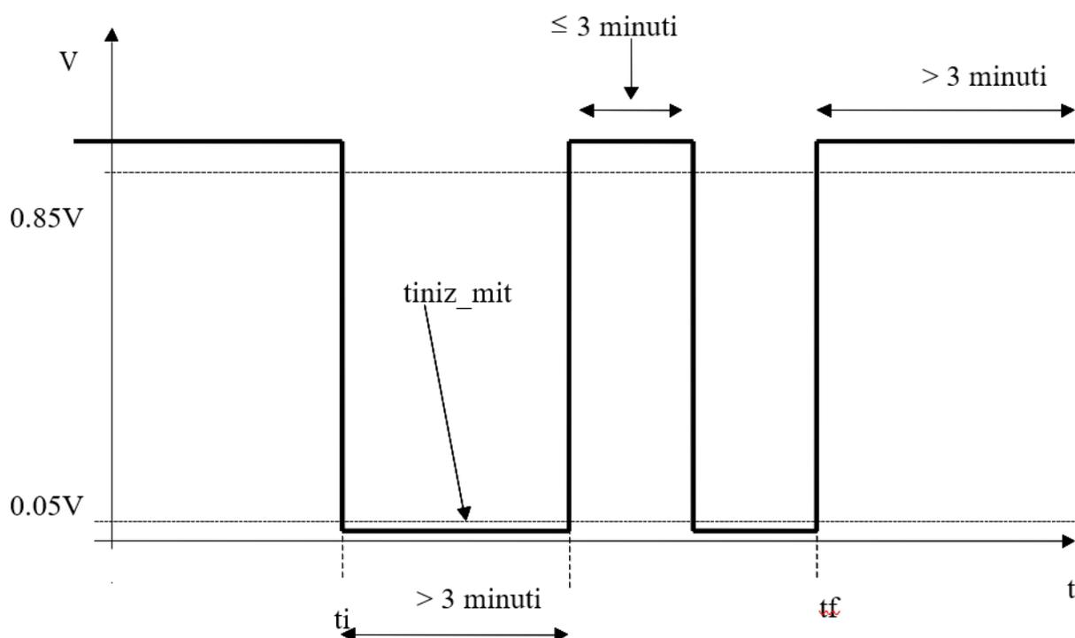
Figura 2 - Calcolo di  $(t_i)$  e  $(t_f)$
