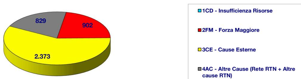
**Figura 10 - Energia non fornita (MWh) suddivisa per Codice Causa 1° livello di aggregazione (compresi gli Incidenti Rilevanti) nell'anno 2017**
