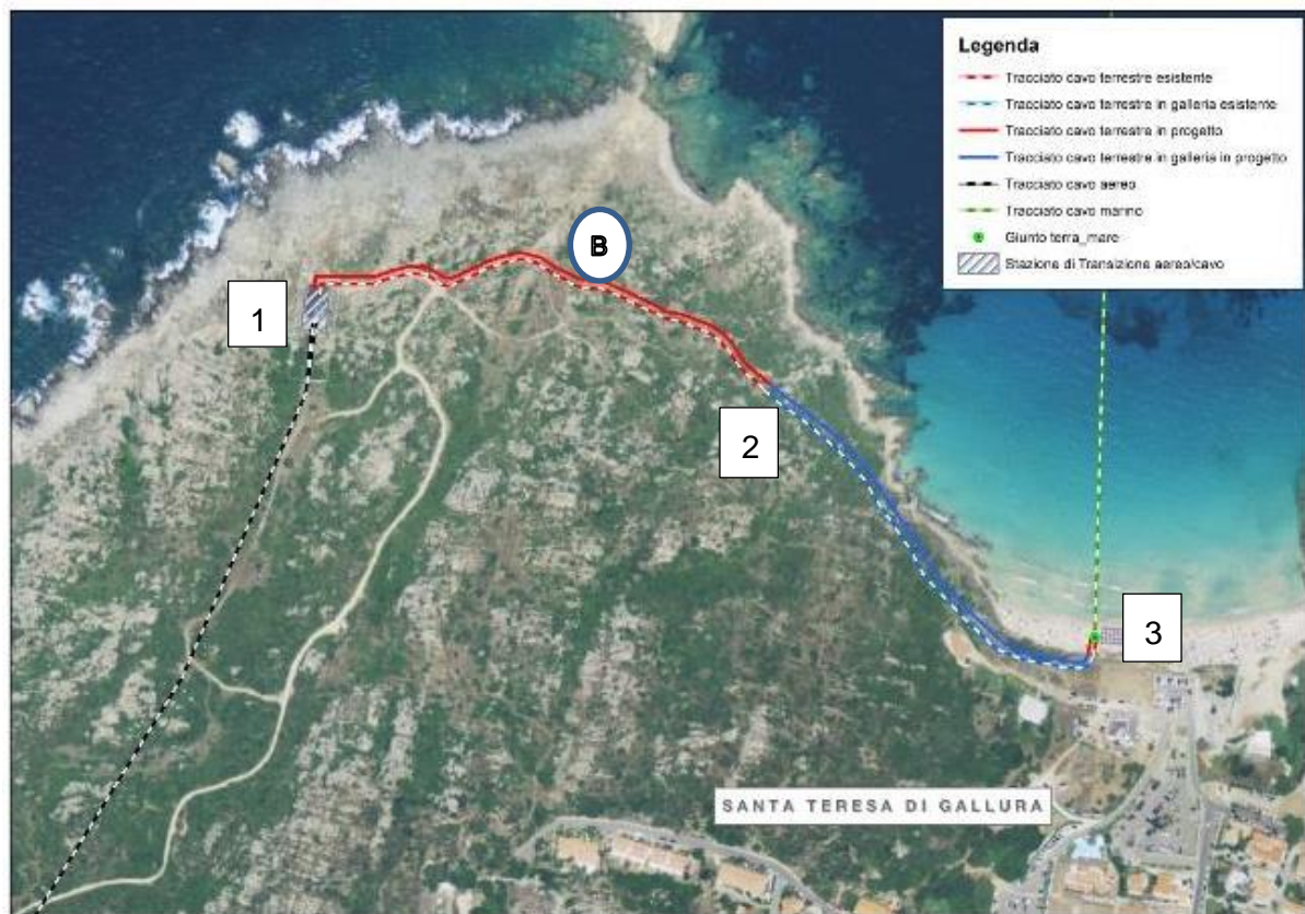
Figura 5 – Tracciato proposto per i cavi terrestri di polo in località Santa Teresa di Gallura (SS)
