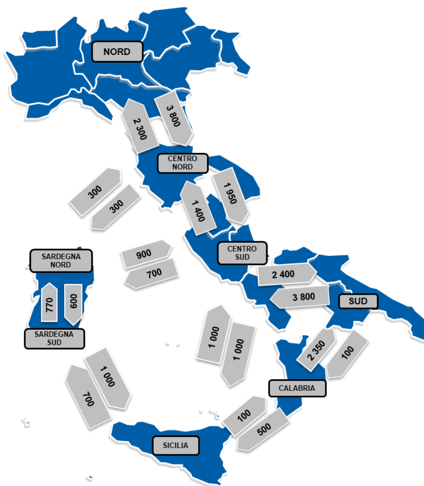
Figura 26 - Massimo ammontare di CDP scambiabile tra singole aree limitrofe senza che si innalzi il valore di LOLE di sistema elettrico – Punto D
