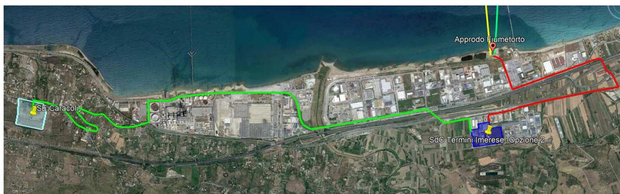
**Figura 16 – Tracciato dei cavi HVAC 380 kV (in verde) fra l'opzione 2 di localizzazione della stazione di conversione e la SE Caracoli (fonte Google Earth)**
